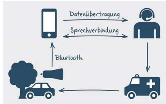
meldestecker per Bluetooth entgegen, reichert diese durch die Positionsdaten und die letzte Fahrtrichtung an und sendet sie an die Notruf-Zentrale. Gleichzeitig wird automatisch eine Sprechverbindung zur Notruf-Zentrale aufgebaut und nachgefragt, ob der Fahrer Hilfe benötigt. Antwort der Fahrer nicht oder braucht er Hilfe, infor-
